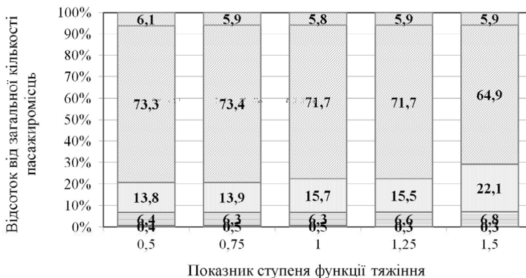
Рисунок 2 – Розподіл загальної кількості пасажиромісць для різних місткостей транспортних засобів залежно від показника ступеня функції тяжіння:
