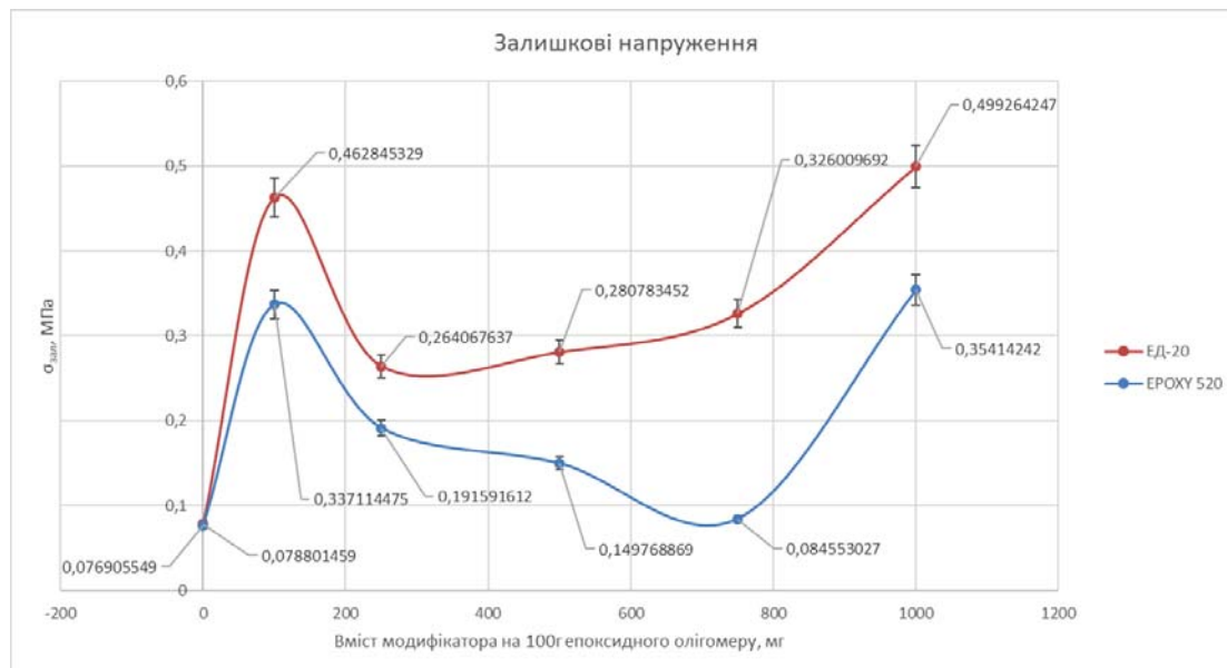
Рисунок 2 – Залежність залишкових напружень епоксидної матриці (ЕД-20 та ЕРОХУ 520) від вмісту модифікатора ТМХС-1
