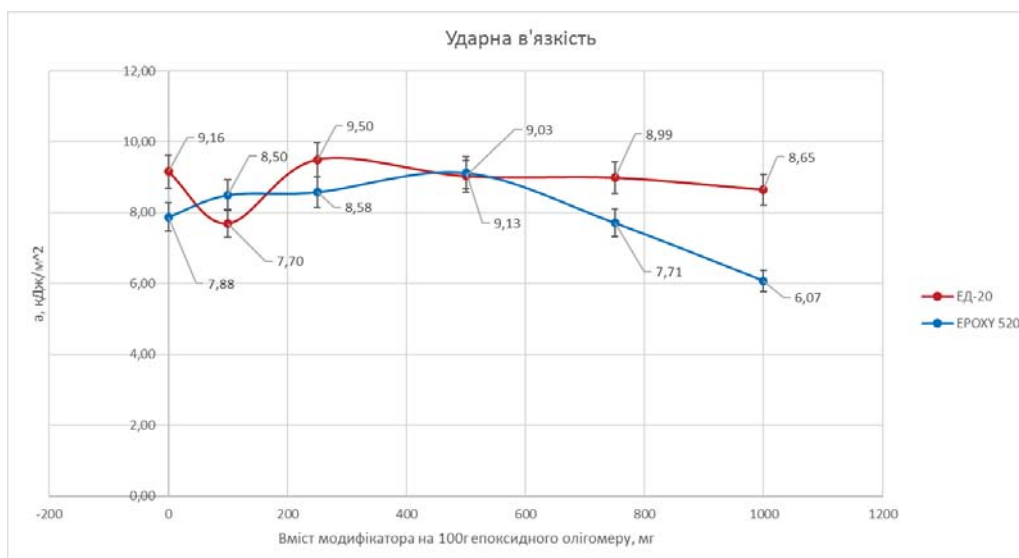
Рисунок 5 – Залежність ударної в'язкості з'єднань епоксидної матриці (ЕД-20 та ЕРОХУ 520) від вмісту модифікатора ТМХС-1
